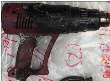
Pistola térmica recuperada del incendio (crédito: Junta de Seguridad Química de EE. UU.)
