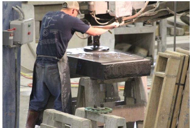
Un trabajador utiliza una amoladora de piedra que aplica agua en la superficie de trabajo para reducir los niveles de polvo de sílice en el aire.
