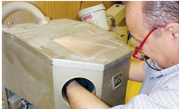
Mientras realiza el chorreado abrasivo de fundiciones dentales, un trabajador utiliza un recinto que aísla el polvo de sílice.
