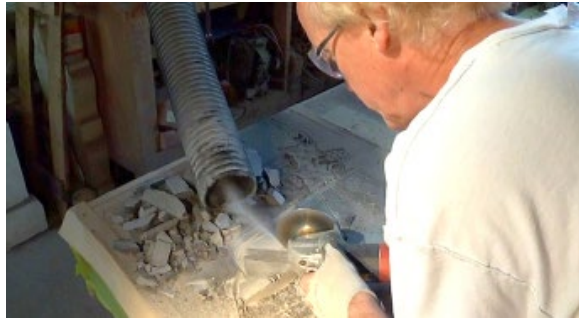
Mientras muele piedra, un trabajador utiliza ventilación local para eliminar el polvo de sílice y reducir su exposición.
