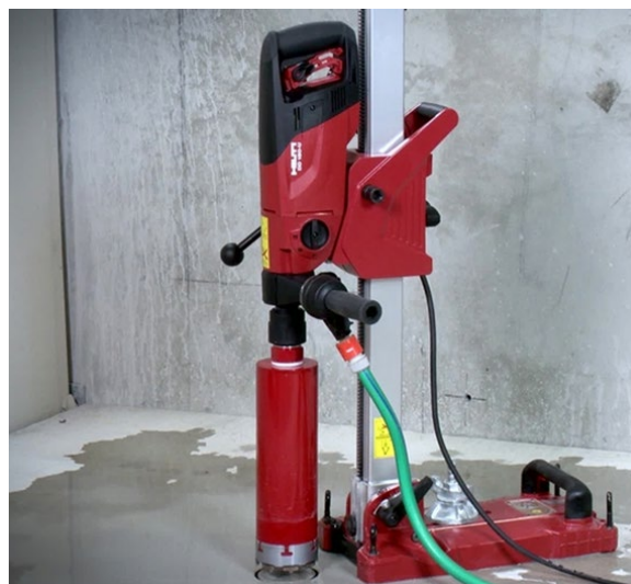
Máy khoan lõi gắn trên giàn khoan với hệ thống cấp nước tích hợp.
