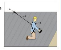
Recuerde que cuando se trata de sistemas de detención de caídas, los trabajadores deben usar arneses de cuerpo entero. Los cinturones de seguridad pueden causar lesiones graves durante una caída y la OSHA prohíbe su uso como parte de los sistemas de detención de caídas.
