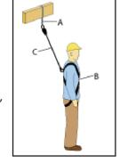
Recuerde que cuando se trata de sistemas de detención de caídas, los trabajadores deben usar arneses de cuerpo entero. Los cinturones de seguridad pueden causar lesiones graves durante una caída y la OSHA prohíbe su uso como parte de los sistemas de detención de caídas.
