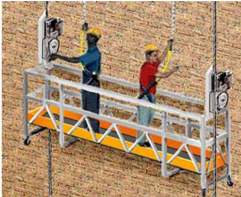
1926.451(g)(4)(x) Los mecanismos de izamiento y estribos pueden usarse como barandales en los extremos de los andamios de suspensión si el espacio entre el mecanismo de izamiento o estribo y el barandal lateral o la estructura no permite que algún empleado pueda pasar al extremo del andamio.
