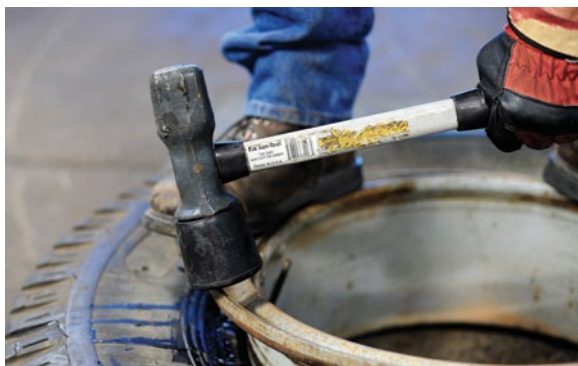
Ensamblando el anillo del rin de multi-pieza con mazo.
