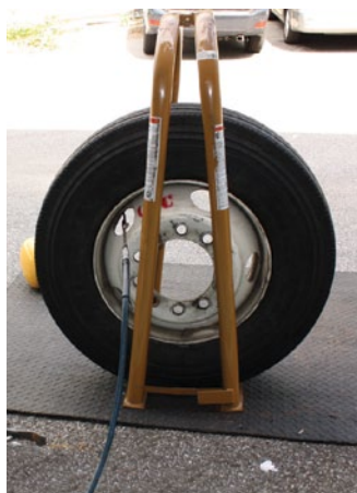
Inflando rin de una pieza en el aparato de restricción.
