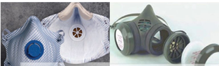
El dispositivo de filtración facial N95 aprobado por el NIOSH (izquierda) y cubrebocas elastomérico de media cara (derecha) pueden usarse sólo si la concentración de sílice es menos de 10 veces mayor que el límite de exposición admisible.
